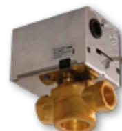
Válvula de zona con cabezal desmontable y micro. Actuador de acero inox. Carcasa de aluminio pulido. Cuerpo válvula de latón. Cierre NBR. Alimentación 220 v / 50Hz. Potencia absorbida 7w. Temperatura máxima del fluido 90°C. Presión máxima 16bar. Tiempo de funcionamiento: Apertura: 10/15". Cierre: 4/5" Funciones del actuador: **Normalmente cerrado**. Tensión para abrir. Retorno por muelle.
