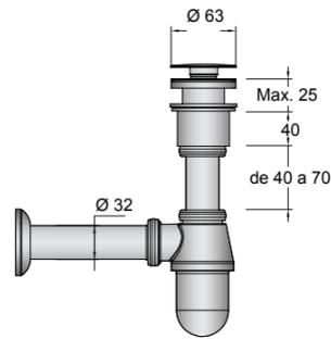
Sifón válvula abierta con desagüe latón cromado
