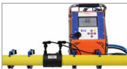
11. Inicio de la soldadura.
